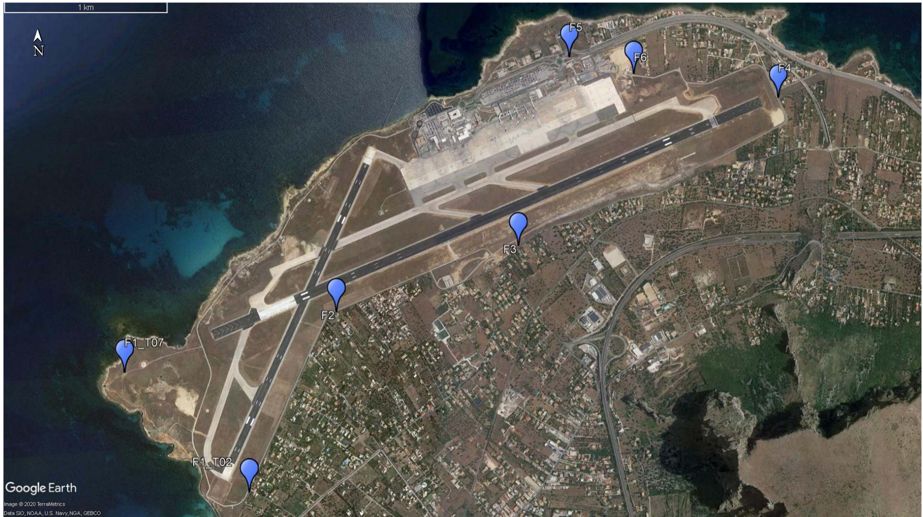
Figura 4. Inquadramento aerofotografico generale con postazione delle centraline per il monitoraggio delle emissioni rumorose – configurazione a regime
